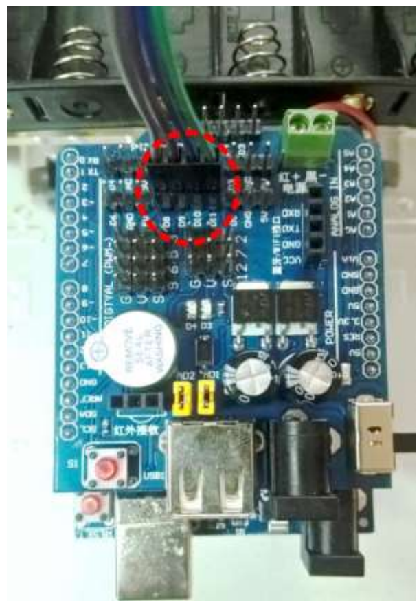
Figure 7 - 2 : Connecteur connecté sur le module Shield
