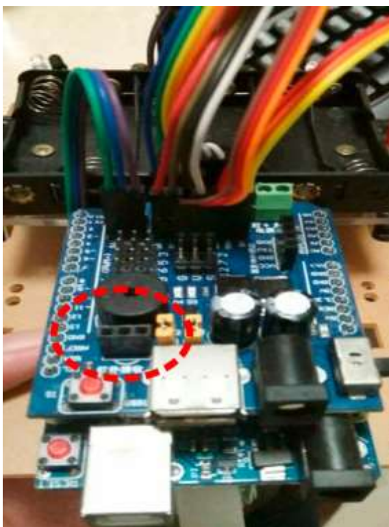
Figure 8 – 3 : Emplacement du socle où le récepteur d'infrarouges doit être connecté.
