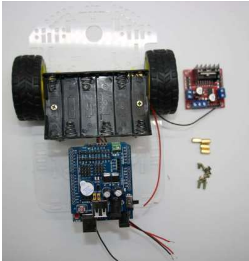
Figure 5- 1 : Pièces que nous utiliserons pour fixer le circuit de contrôle des moteurs
