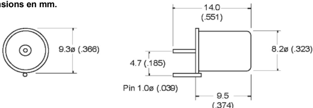
Lors de la coupe aux bornes du capteur, attention à ne pas endommager le verre qui ferme le boîtier métallique. Le terminal ne doit pas être coupé à moins de 3 mm. de la capsule. Au cours de l'opération de découpe, le terminal doit être tenue avec une pince, située entre la capsule et la fréquence de coupure
