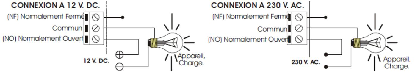
**CONSIDERATIONS SUR LA SORTIE :** Durant le fonctionnement, et selon sa charge, il est possible qu'il se produise une fluctuation ou un fonctionnement incorrect de la sortie. Si cela venait à se produire, placez un circuit "anti-éincelles" entre les deux contacts du relais utilisés pour la connexion (Voir schéma ci-joint).
