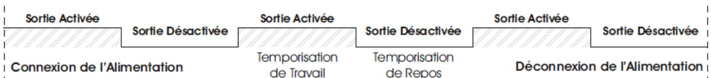
Une fois le temps sélectionné, vous devrez activer l'interrupteur pour alimenter le module. Le module I-11 connectera automatiquement la sortie durant le temps de travail préalablement ajusté, en allumant le led indicateur. Lorsque la temporisation sera fini, le led et la sortie se déconnecteront, demeurant dans cet état pendant le temps de repos que vous aurez établi; et une fois ce temps de repos écoulé le cycle s'initiera de nouveau.
